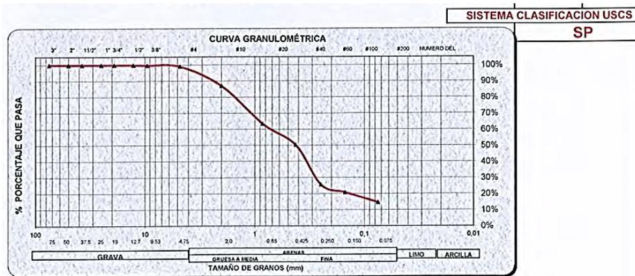
Análisis granulométrico de agregados por medio del hidrómetro (I.N.V. E - 124 - 07- AASHTO T88-00 ASTM D 422-63).
